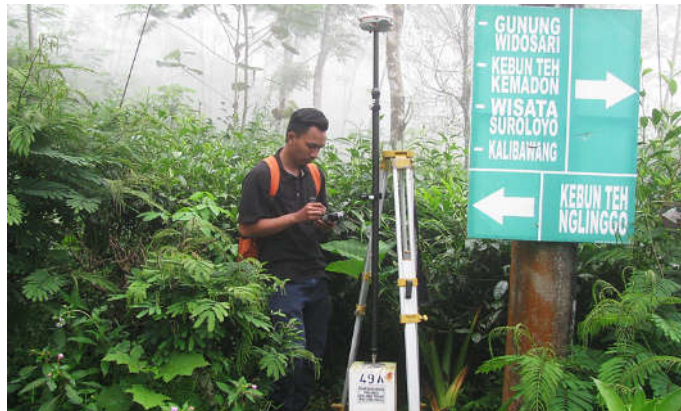
Gambar 8.2. Pengukuran Titik Koordinat Pilar Batas Daerah secara Geodetik Tahun 2018 di Perbatasan Kecamatan Samigaluh dengan Kecamatan Salaman
